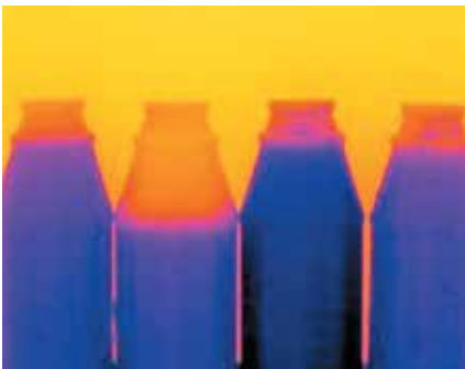
Определение уровней жидкости в непрозрачных бутылках.
