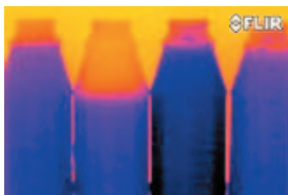
ИК-снимок автоматически заполняемых бутылок. Переполненные или недостаточно заполненные бутылки можно снять
