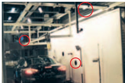
На заводе компании Ford установлено три тепловизионных камеры FLIR для проверки системы обогрева лобового стекла, системы обогрева заднего стекла и системы кондиционирования воздуха. Места установки тепловизионных камер отмечены красным кружком
