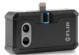
2015 г.: FLIR One, вспомогательное устройство для мобильных телефонов iPhone и Android. Масса: 36 г.
