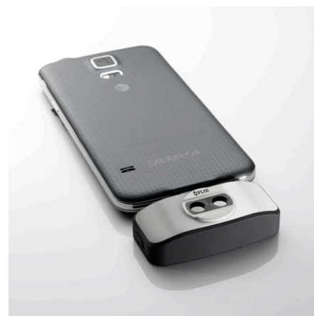
Рисунок 31.3 2015 г.: FLIR One, вспомогательное устройство для мобильных телефонов с операционной системой iPhone и Android. Вес: 90 г. .
