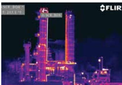
Камера FC серии R позволяет контролировать температуру определенной зоны. Когда достигается или превышаетея предустановленная температура, отправляется уведомление по электронной почте, на цифровой выход или через систему управления видеосигналом.
