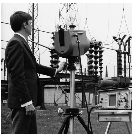
Рисунок 28.2 1969 г.: Thermovision модель 661. Эта камера весила около 25 кг, осциллограф – 20 кг, а штатив – 15 кг. Кроме того, оператору требовался генератор переменного напряжения на 220 В и сосуд на 10 л с жидким азотом. Слева от осциллографа находится фотоприставка Polaroid (6 кг).
