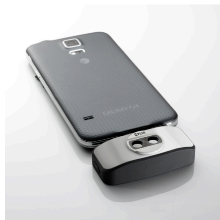
Рисунок 28.3 2015 г.: FLIR One, вспомогательное устройство для мобильных телефонов с операционной системой iPhone и Android. Вес: 90 г. .
