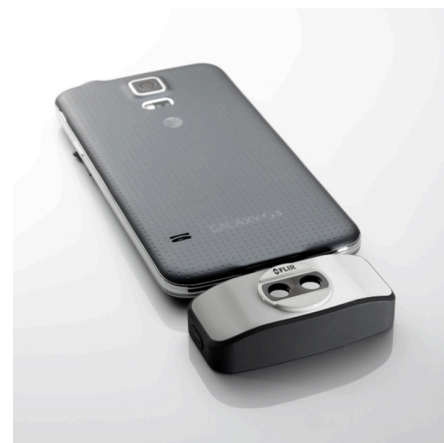
Рисунок 13.3 2015 г.: FLIR One, приложение для мобильных телефонов с операционной системой iPhone и Android. Вес: 90 г.
