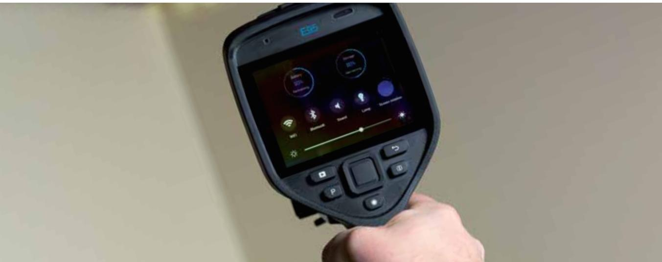
Камеры серии Exx имеют все необходимое для быстрого обнаружения скрытых строительных дефектов и пересылки отчета о проблеме: превосходную термочувствительность, яркий дисплей, функцию тонкой фокусировки и быстрый интерфейс.
