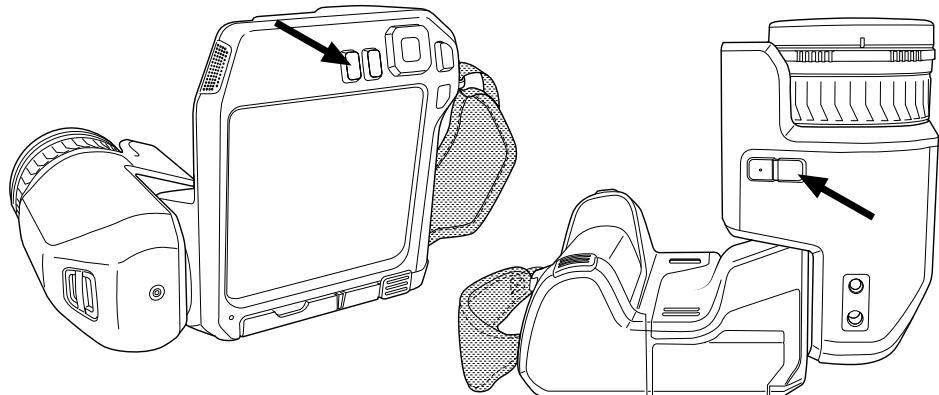
Предусмотрены две отдельных программируемых кнопки: одна над экраном, а вторая в нижней части корпуса оптической системы.
