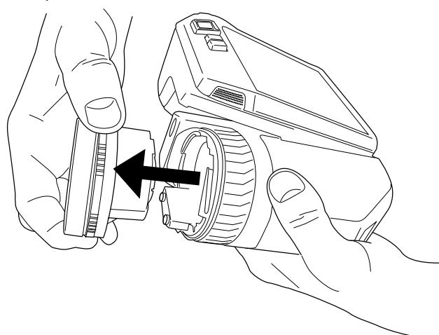
3. Теперь инфракрасный детектор полностью открыт. Не прикасайтесь к этой поверхности. Если на детекторе присутствует пыль, следуйте инструкциям из раздела 24.3 *Инфракрасный детектор*.
