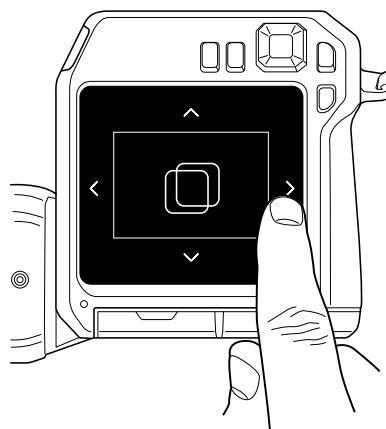
Чтобы повторить процедуру позже, перейдите в *Settings* (Настройки) > *Device settings* (Информация об устройстве) > *Camera information* (Информация о камере) > *Calibration* (Калибровка) > *Calibrate lens...* (Калибровка объектива).
