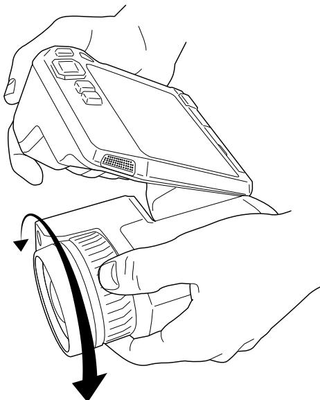
**Примечание** Не прикасайтесь к поверхности линзы при регулировке фокусировки. Если вы прикоснулись к линзе, очистите ее в соответствии с инструкциями в 24.2 Инфракрасный объектив.
