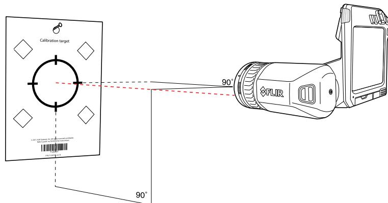
5. Совместите инфракрасное и визуальное изображение в камере (обозначены двумя квадратами на рисунке ниже) с помощью стрелок на сенсорном экране. Теперь комбинация «объектив–камера» откалибрована.
