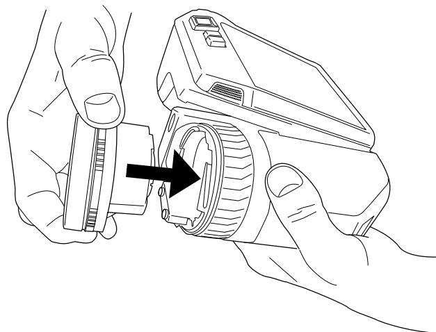
6. Поверните внутреннее кольцо объектива на  $30^\circ$  по часовой стрелке. При фиксации объектива на месте слышится щелчок.
