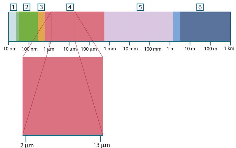
**Рисунок 26.1** Спектр электромагнитного излучения 1: Рентген. лучи; 2: УФ; 3: Видимый; 4: ИН; 5: Микроволны; 6: Радиоволны.
