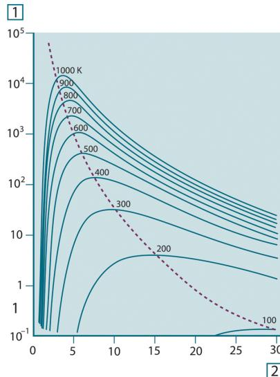
**Рисунок 26.6** Кривые Планка, построенные в полулогарифмическом масштабе от 100 К до 1000 К. Пунктирная линия представляет геометрическое место точек максимума излучательной способности при каждой температуре согласно закону смещения Вина: 1: Спектральная излучательная способность ( $\text{Вт}/\text{см}^2 (\text{мкм})$ ); 2: Длина волны ( $\text{мкм}$ ).
