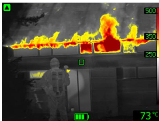
Рисунок 20.8 Режим пожара.
