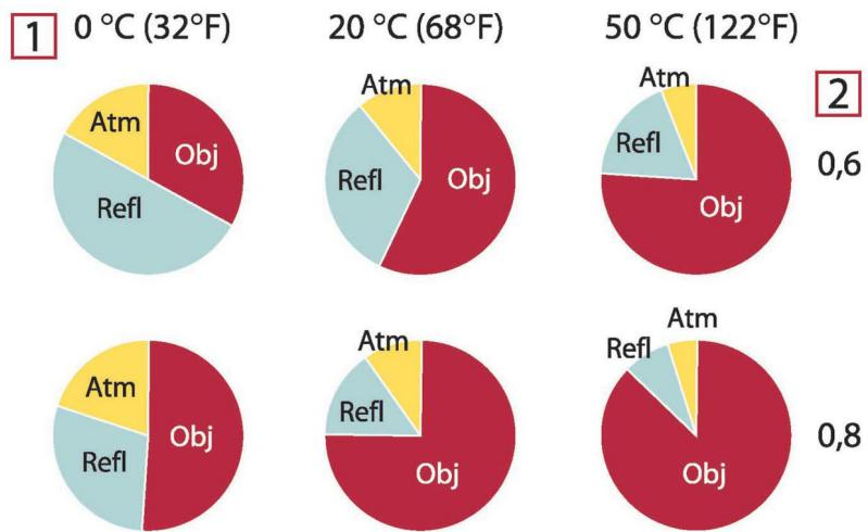
**Рисунок 27.2** Относительные величины источников излучения при различных условиях измерений (SW-камера). 1: Температура объекта; 2: Светимость; Obj: Излучение объекта; Refl: Отраженное излучение; Atm: излучение атмосферы. Фиксированные параметры:  $\tau = 0,88$ ;  $T_{\text{refl}} = 20^{\circ}\text{C}$ ;  $T_{\text{atm}} = 20^{\circ}\text{C}$ .
