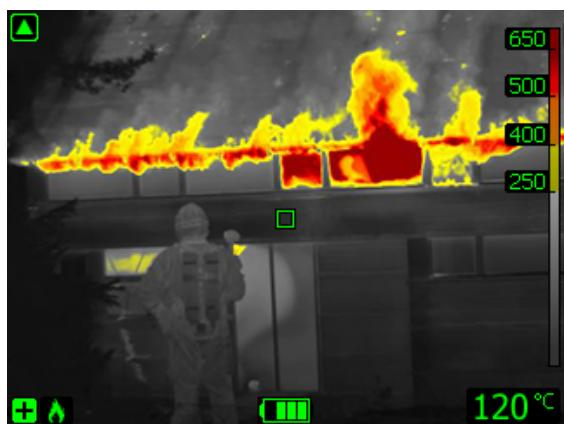
Рисунок 20.3 Режим пожара.
