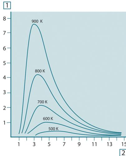
**Рисунок 26.4** Кривые спектральной излучательной способности черного тела в соответствии с законом Планка, построенные для разных значений абсолютной температуры 1: Спектральная излучательная способность ( $\text{Вт}/\text{см}^2 \times 10^3(\text{мкм})$ ); 2: Длина волны ( $\text{мкм}$ ).
