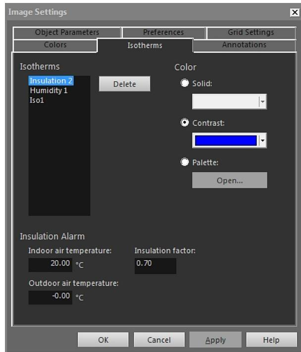
**Температура в помещении:** Этот параметр отражает температуру окружающего воздуха внутри изучаемого здания при установке тревоги по теплоизоляции. С помощью тревоги по изоляции можно обнаружить дефект изоляции в стене.
