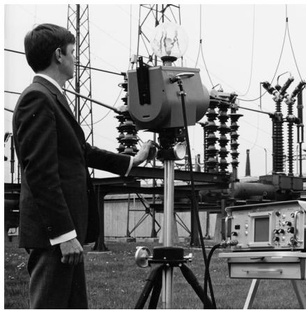
**Рисунок 22.2** 1969 г.:Thermovision модель 661. Эта камера весила около 25 кг, осциллограф – 20 кг, а штатив – 15 кг. Кроме того, оператору требовался генератор переменного напряжения на 220 В и сосуд на 10 л с жидким азотом. Слева от осциллографа видна фотоприставка Polaroid (6 кг).
