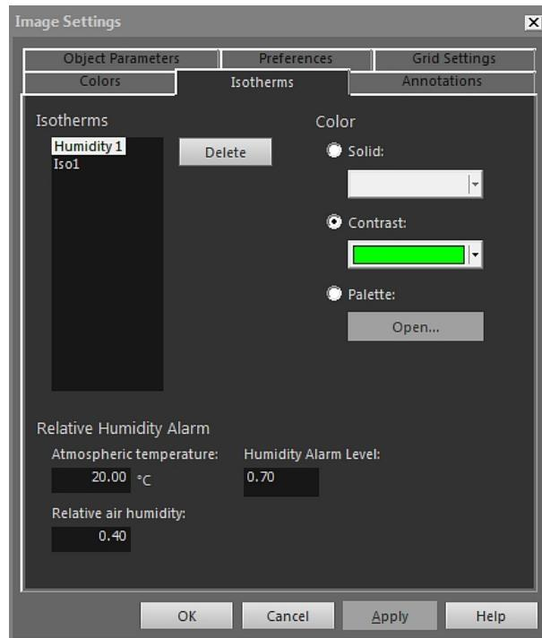
**Температура воздуха:** этот параметр отражает температуру окружающего воздуха при настройке тревог по влажности. Тревога по влажности позволяет обнаруживать область, в которой может существовать риск повышения влажности в конструкции здания.
