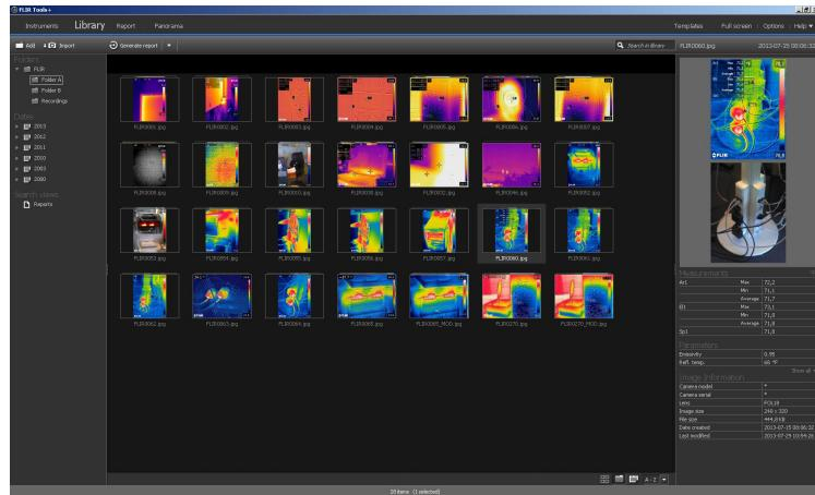
FLIR Tools/Tools+ – это пакет программного обеспечения предназначенный для обновления встроенной программы вашей камеры, а также для создания отчетов по результатам измерений.
