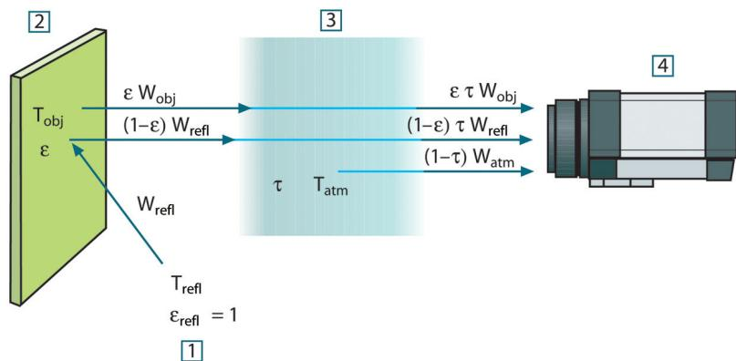
**Рисунок 27.1** Схематическое представление ситуации при общих термографических измерениях
