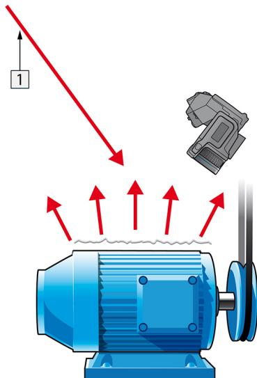
Рисунок 24.5 Измерение видимой температуры от алюминиевой фольги.
