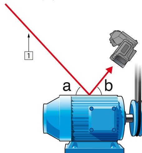
Рисунок 24.1 1 = источник отраженного излучения
