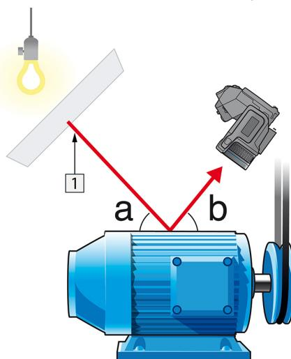
Рисунок 24.2 1 = источник отраженного излучения
