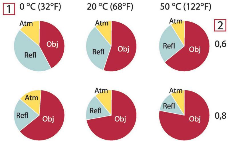
**Рисунок 27.3** Относительные величины источников излучения при различных условиях измерений (SW-камера). 1: Температура объекта; 2: Светимость; Obj: Излучение объекта; Refl: Отраженное излучение; Atm: излучение атмосферы. Фиксированные параметры:  $\tau = 0,88$ ;  $T_{\text{refl}} = 20^{\circ}\text{C}$ ;  $T_{\text{atm}} = 20^{\circ}\text{C}$ .
