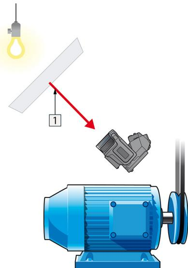
**Рисунок 24.4** 1 = источник отраженного излучения
