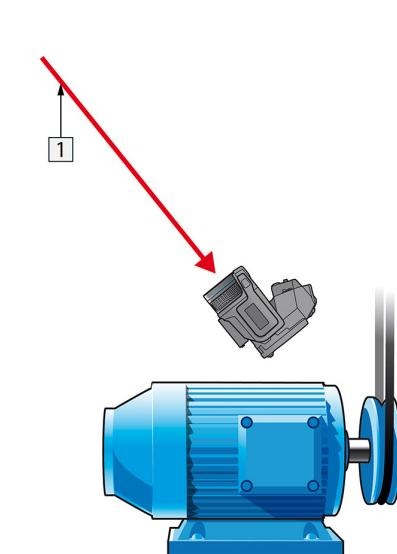
**Рисунок 24.3** 1 = источник отраженного излучения
